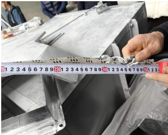
图3 工作绳破断部位与锚固点距离
