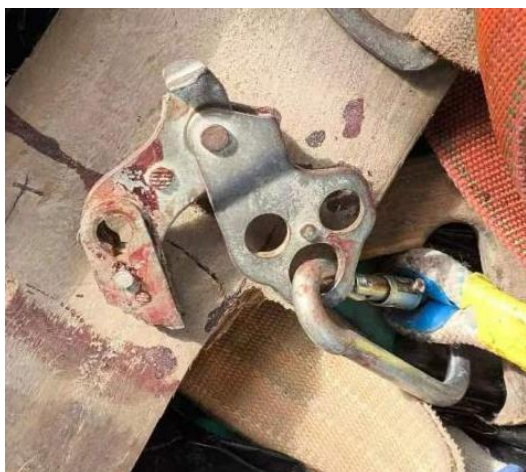
图 10 现场损坏的自锁器
